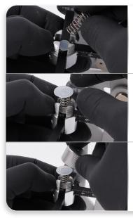
Auf die kleine Polyamidscheibe muss nun die Druckfeder aufgesetzt werden. The pressure spring must now be placed on the small poliamid disc.
